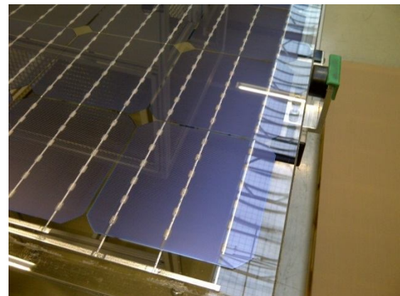
Abbildung 3: Bifaciales Laminate in Produktionslinie (Blick auf Rückseite).
